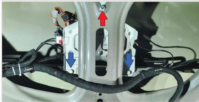
**4** Снимите разъемы камеры и кнопки открывания багажника. Сожмите клипсы и снимите наружную ручку багажника в сборе.
