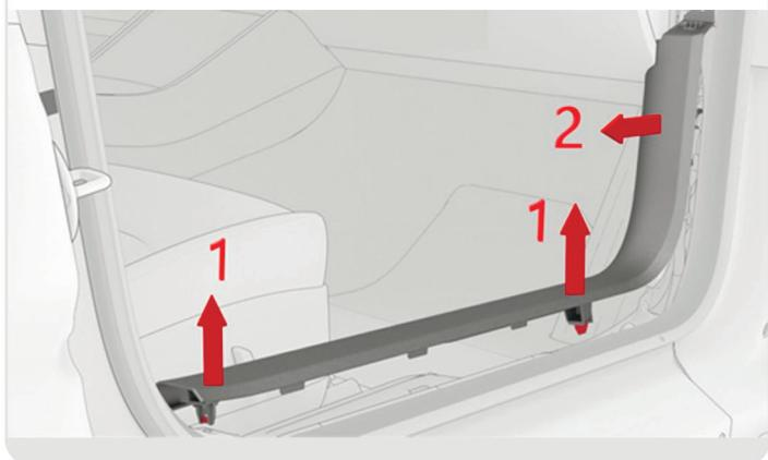
**10** Разберите правый порог заднего пассажира в салоне автомобиля. Проложите шланг из передней в заднюю часть автомобиля.
