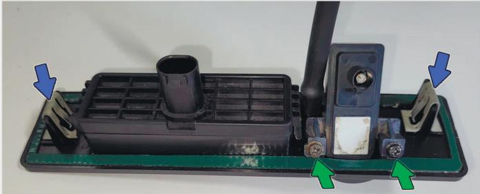
**7** Обезжирьте посадочное место камеры на кузове с помощью салфетки из комплекта, отклейте защитную пленку двустороннего скотча с нового кронштейна и установите наружную ручку в штатное место. Прижмите по периметру для надежного приkleивания скотча. Подключите разъемы камеры и кнопки открывания багажника.
