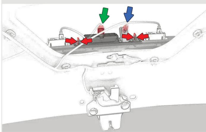
**5** **Выверните 2 винта**, снимите камеру. **Освободите 2 зажима** и снимите кнопку открывания багажника. С помощью плоской отвертки либо шила **снимите 2 клипсы**.
