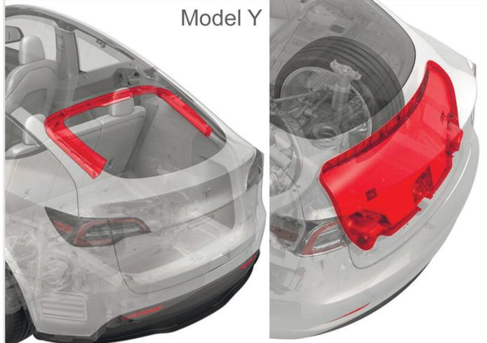
**3** **Только для Model Y:** Для доступа к камере **отверните 2 болта**, **ослабьте гайку**, затем отодвиньте усилитель радиосигнала.
